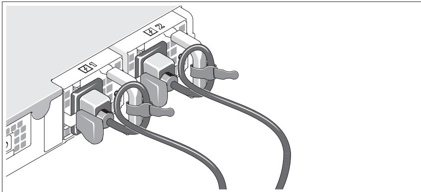
システムに電源コードを接続します（図は冗長システム）。冗長システムの場合は、システムに付属の 2 本のベルクロストラップを使用して、ケーブルを固定します（図を参照）。非冗長システムの場合は、システムに付属の電源ケーブル固定ブラケットを取り付けます。
