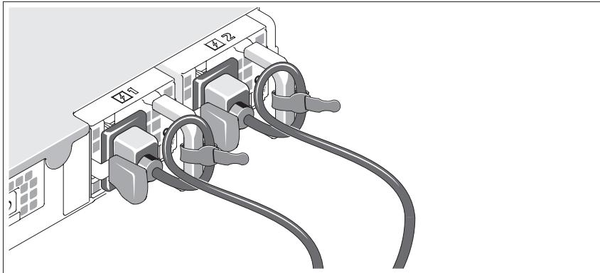
将系统的电源电缆连接到系统上（示意图中显示一个冗余系统）。对于冗余系统、请使用系统随附的两个 Velcro 紧固带固定电缆、如图所示。对于非冗余系统、使用系统随附的电源线固定支架固定电缆。
