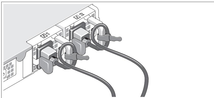
시스템의 전원 케이블을 시스템에 연결하십시오(중복되는 시스템이 그림에 표시됨). 중복되는 시스템의 경우 시스템과 함께 제공되는 2개의 벨크로 테이프로 케이블을 고정시키십시오. 중복되지 않는 시스템의 경우 시스템과 함께 제공되는 전원 코드 고정 브래킷을 장착하십시오.
